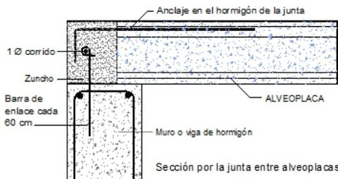
APOYO EXTERIOR SOBRE MURO O VIGA DE HORMIGÓN
